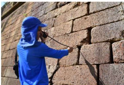
Figura 8: Prospecção, com endoscópio, em lacunas da muralha Fonte: Acervo dos autores, 2020
