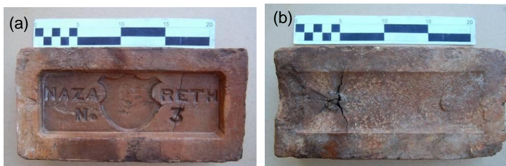
Figura 6 – Tijolo maciço prensado encontrado no frontão da Igreja do Boqueirão: (a) Vista superior; (b) Vista inferior Fonte: Acervo Francisco Santana
