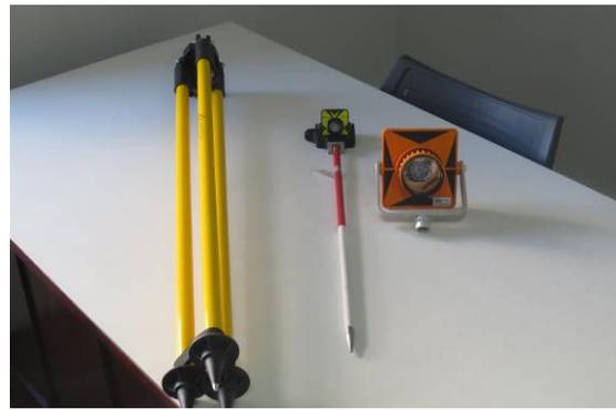
**Imagens 08 e 09:** Alvo Esfera e Alvo Plano Adesivo e Tripé Bastão, Baliza, Mini Prisma e Prisma – arquivo Retrô, 2016.
